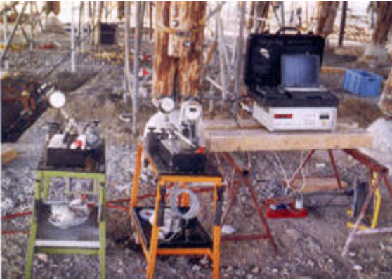
27) "Bild 33. Meßstand mit Hydraulikpumpenwagen und Online Meßanlage"
