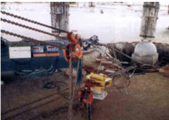
24) "Bild 21. Rahmentest durch Kettenzüge gegen die Fundamente"
