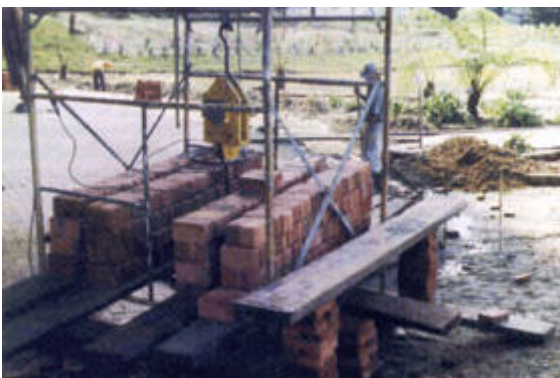
25) "Bild 18. Kragdach-Testmasse aus Pflastersteinen"
